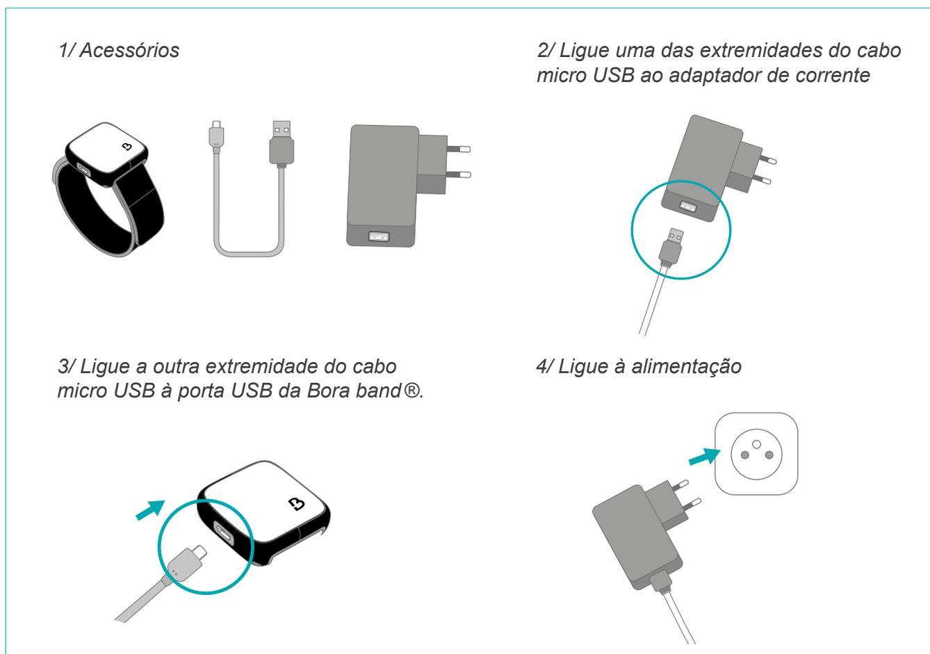
Figura 9 : Carga da bateria
