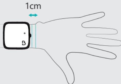
Das Bora band® BB100 muss gut angepasst werden, sodass es ohne Unbehagen leichten Druck auf Ihre Haut ausübt. Dies gewährleistet die Genauigkeit der Messwerte.
