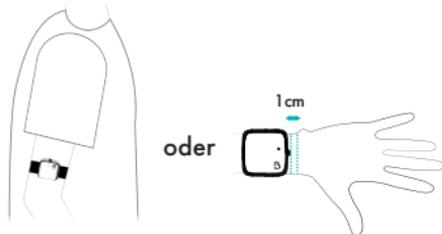
Das Gerät Bora band® BB100 muss gut angepasst werden, sodass es ohne Unbehagen leichten Druck auf Ihre Haut ausübt. Dies gewährleistet die Genauigkeit der Messwerte.
