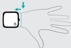
Le BORA Band BB100 doit être bien ajusté sur votre poignet afin de garantir la précision de mesure, sans ressentir d'inconfort.
