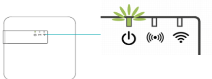
Figure 6 : Indicateur lumineux pour le mode maintenance
