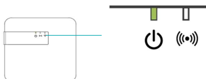
Figura 10: comprobación del buen funcionamiento del terminal
