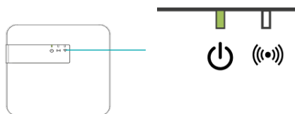
Figure 17: Vérification du bon fonctionnement de la borne
